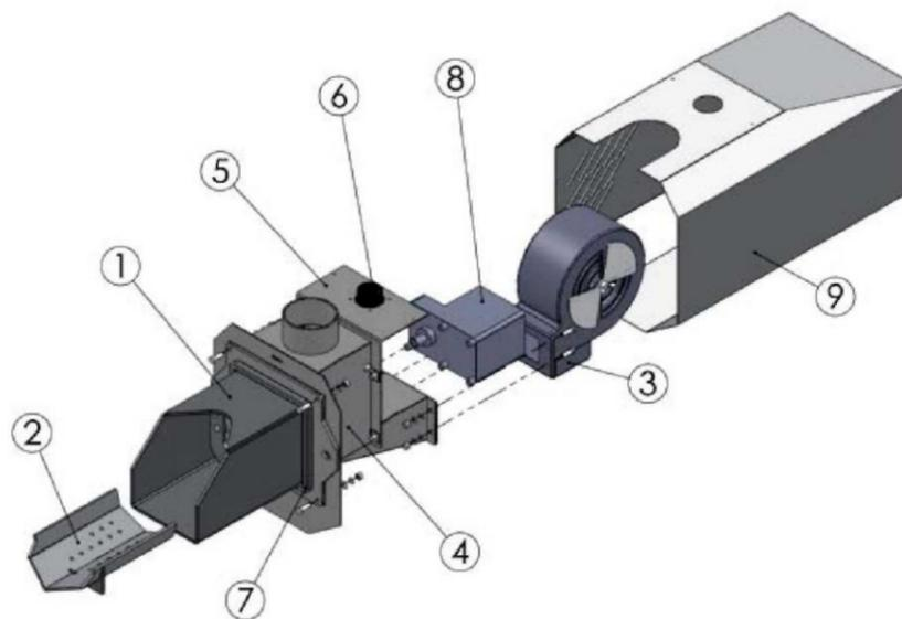
Рис. 10 Описание конструкции горелки Платинум Био
