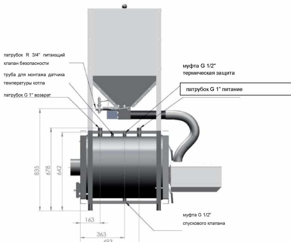
Рис. 02. Размещение и размеры присоединительных патрубков.
