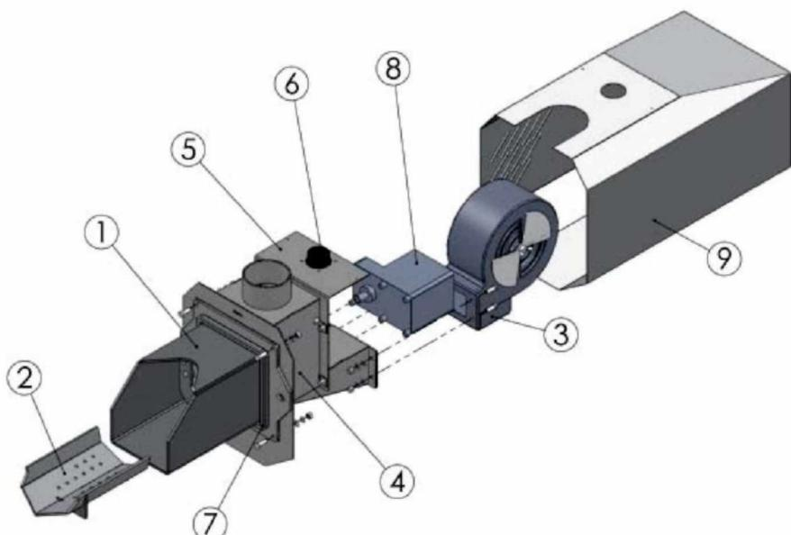
Рис. 10 Описание конструкции горелки Платинум Био
