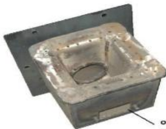
Рисунок 13. Отверстие для чистки горелки.
